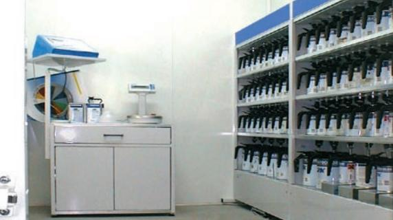
Le Mixing Box est un local adapté pour la préparation des produits de peinture, doté de luminaire, ventilation, d'une porte de service avec une fermeture anti-panique.
